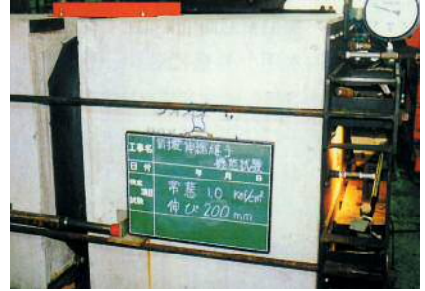
水圧確認試験
