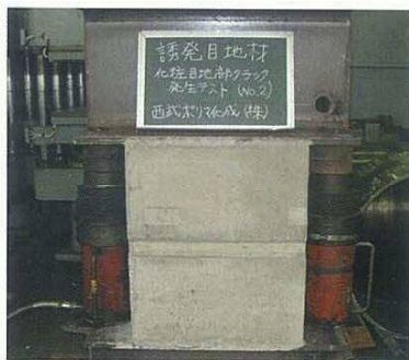
化粧目地部クラック発生試験
