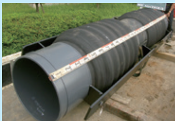
ダクタイル鋳鉄管挿口タイプ
