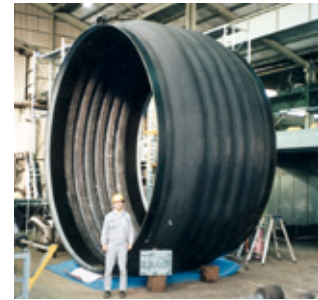
口径 5000mmの製造例
