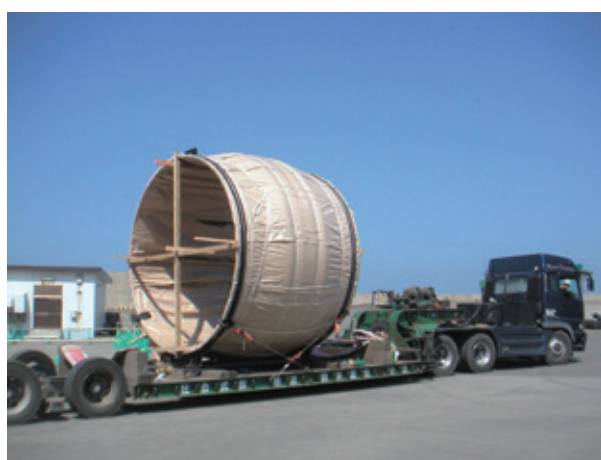
【口径3800mm 梱包、運搬状況】
